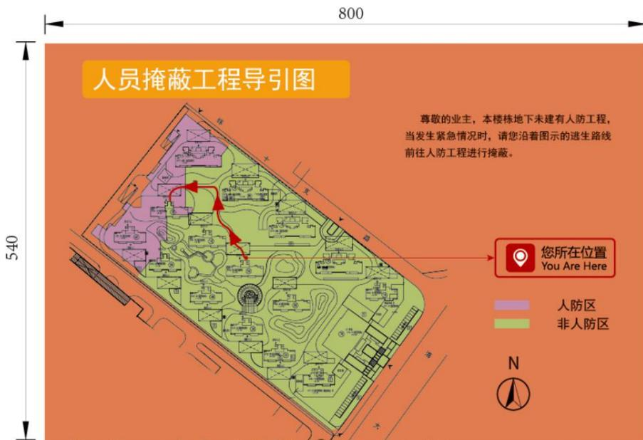
图 3-5 本楼栋地下不能直通人员掩蔽工程导引图标识牌样式及尺寸示例
