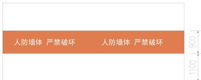
图 3-15 区域围护面积大于等于 200m<sup>2</sup>时墙面喷涂标识样式及尺寸示例
