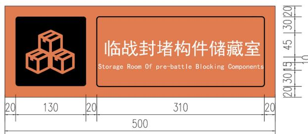
图 4-5 临战封堵构件储藏室标识牌样式、尺寸示例
