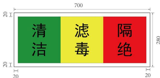
图 5-1 通风方式显示装置样式及尺寸示例
