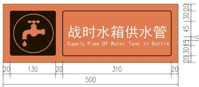
图 4-4 战时水箱供水管标识牌样式、尺寸示例
