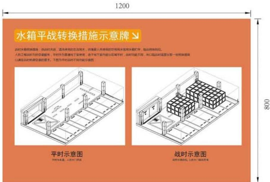
图 4-7 水箱平战转换措施示意牌样式、尺寸示例
