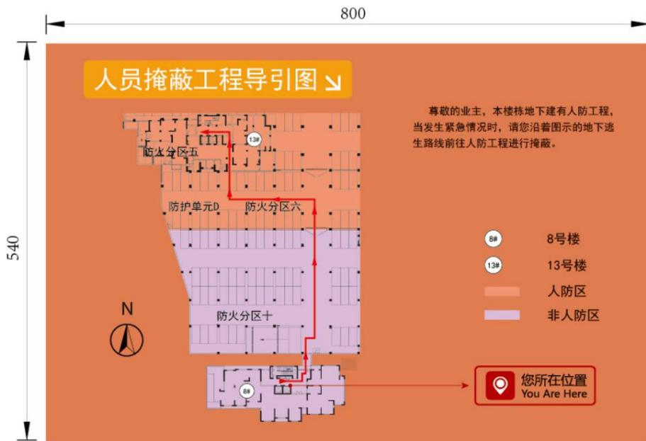
图 3-4 本楼栋地下能直通人员掩蔽工程导引图标识牌样式及尺寸示例
