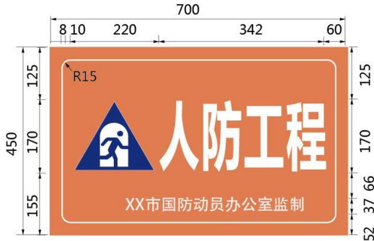
图 3-14 人防工程提示牌 (大) 样式及尺寸示例
