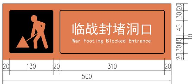
图 4-3 临战封堵标识牌样式及尺寸示例
