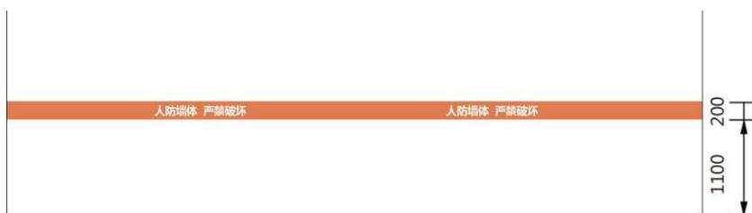
图 3-16 区域围护面积小于 200m<sup>2</sup>时墙面喷涂标识样式及尺寸示例
